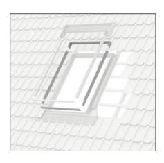
Der Eindeckrahmenadapter ELX wird zusätzlich zum Eindeckrahmen benötigt, wenn Dachfenster früherer Generationen (vor 2000) durch solche der neuenGeneration ersetzt werden und die Innenverkleidung (Einbauhöhe) auf dem alten Niveau belassen wird.
