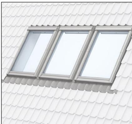
Avec les raccordements combinés VELUX, il est possible d'installer plusieurs fenêtres juxtaposées et/ou superposées.
