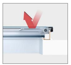
Die Montage erfolgt vom Dach aus, idealerweise durch den Handwerker zusammen mit dem Flachdach-Fenster. Es kann genau ein Sonnenschutzprodukt integriert werden.
