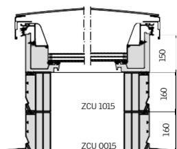
Flachdach-Fenster CVU/CFU mit Aufsetzkranzen ZCU 0015 und ZCU 1015
