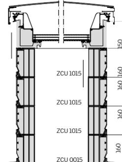
Flachdach-Fenster CVU/CFU mit Aufsetzkranz-Set ZCU S000, bestehend aus Aufsetzkranzen ZCU 0015 und ZCU 0015 + zusätzliche Aufsetzkranz-Adapter ZCU 1015. Es können bis zu drei Aufsetzkranz-Adaptern ZCU 1015 gestapelt werden.
